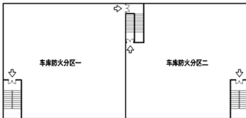
图 3.2b 地下车库借用剪刀楼梯疏散示意图
